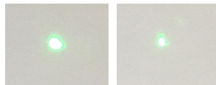
図 11 KTN 結晶レンズへ印加する電圧を 0～1000V に変化させた際の ppKTP 結晶により発生させた SHG 光の Far field 像。
