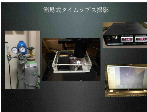
装置全体 ガス微量調節弁、CO 2 チャンバー チャンバー内温度調節器等
