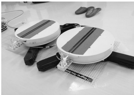
図1 ジャイロメディメータの全景 上部：回旋角度測定部(直径31cm) 下部：三脚部が重心動揺計
