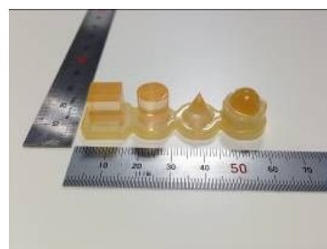
図2、三次元プリンタで最初に合成させた単純構造体
