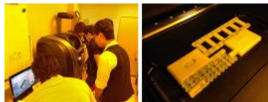
図3、一回目の事業として学生が提案したそれぞれのオリジナルな名刺ケース、釣りの道具、バイク用の特殊な工具の三次元造形例
