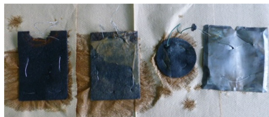
図2 左から正極: 炭素繊維(15cm×10cm)、負極: 炭素繊維(15cm×10cm、微生物膜付き)、グラファイト繊維(直径9cm、微生物膜付き)、グラファイトシート(15cm×15cm)
