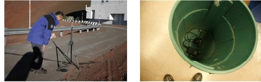
図 7：すばる望遠鏡サイトにおける環境音響雑音調査(左)と簡易遮音筒(右)
