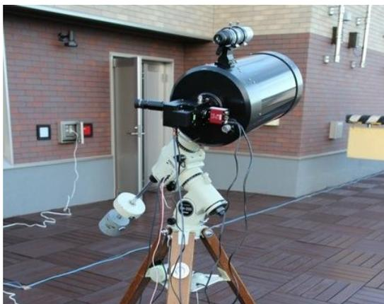
図9: ピリカ望遠鏡における MASS-DIMM
