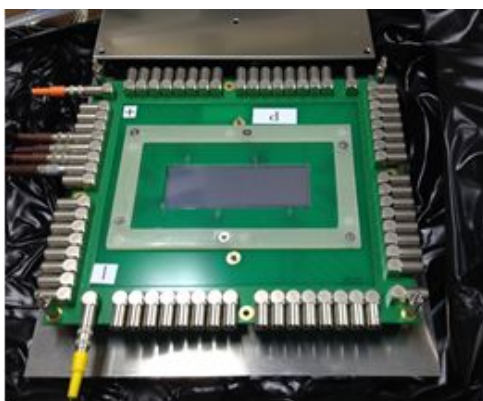
図 3. 製作したシリコンマイクロストリップ検出器読み出しボード。中央にあるのがシリコンマイクロストリップ素子である。
