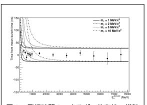
図1;飛行時間のエネルギー依存性。横軸が推定されたニュートリノエネルギー、縦軸が飛行時間の特殊相対論予測からのずれ。どのエネルギー領域でも特殊相対論からのずれがないことが分かる。
