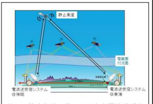
図2;静止衛星を使った双方向電波送受信 精密較正システム(NICT 藤枝氏のスライ ドを参照)
