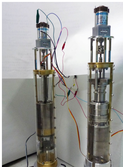
図2:シングルフォース震源の試作モデル。左側は、「ドアノブ型」の落下機構を持つモデル。右側は、ホースジョイント型の落下機構を持つモデル。
