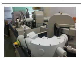
図1負イオン測定がタンデム質量分析装置
