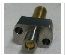
図3開発したアルカリ金属封入セル
