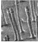
図2 シリカ微粒子を配列させた高配向性グラファイト結晶の酸素プラズマエッチングにより作製されたグラファイト柱の走査型電子顕微鏡像
