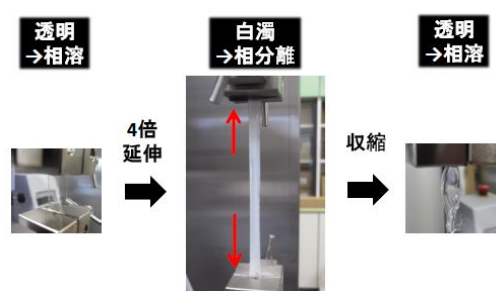
図6 材料(v)のLFなしの厚膜の延伸時の白濁の様子
