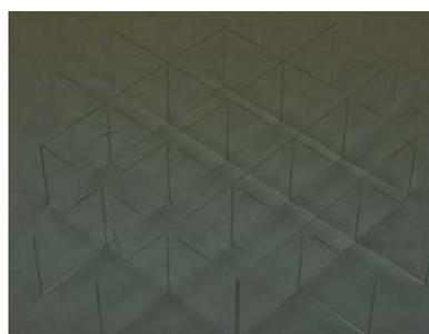
図6 透明アクリル板を用いた音の空中結像用直交ミラーアレイ。
