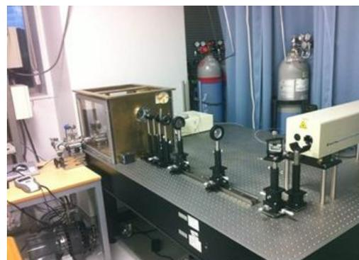
図2 レーザー加工システムの写真。右端がレーザー本体である左奥が加工部である。
