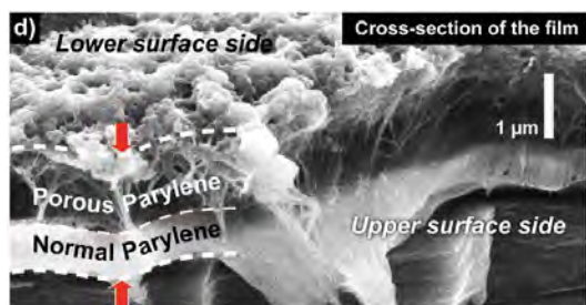
図 2-1 パリレン膜断面の SEM 写真（上が液体との接触面）
