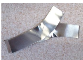
図3 FeならびにNi板の積層圧延時の乖離
