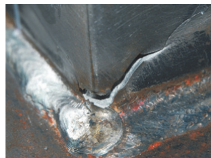
図-12 溶接止端部でのき裂 (支圧拘束板(板厚 12mm)供試体)
