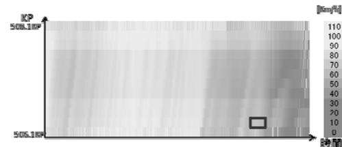
図5 交通状態推定手法による速度コンター
