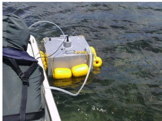
図2 大気と海水の間の CO 2 吸収・放出(フラックス)を観測する装置. 上: 渦相関システム(大気中 CO 2 濃度と鉛直風速の変動成分を連続観測する手法), 下: チャンバーシステム(チャンバー内に閉じ込められた大気中の CO 2 濃度の経時変化を観測する手法).
