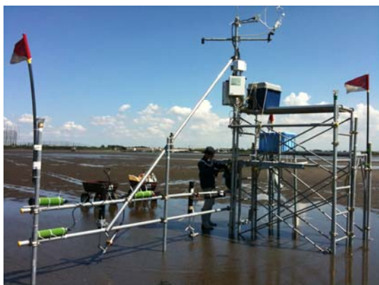
図6 本研究で開発した，大気－海水間CO 2 フラックスと海水－底生系間O 2 フラックスを，長期間広範囲連続で同時に計測可能なシステム（盤洲干潟）
