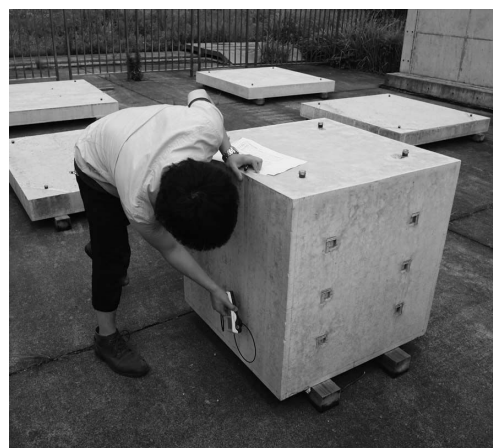
写真1 IC タグの通信可能深さの測定
