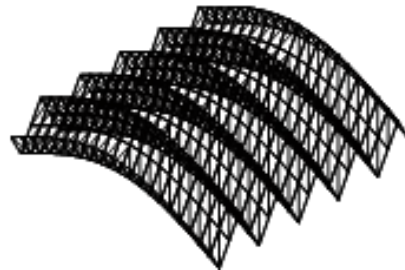
図7 正弦波で風紋と砂丘を単純化した構造モデル
