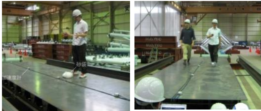
図9 砂袋落下試験と歩行振動試験の様子
