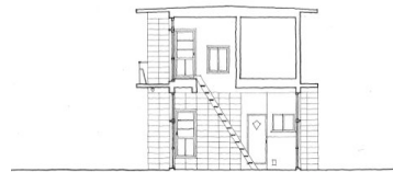
図8 小菅百寿によるCB造2階建戸建住宅の実測断面図
