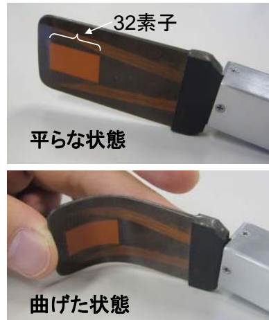
図 3 設計・試作したフレキシブルアレイ探触子
