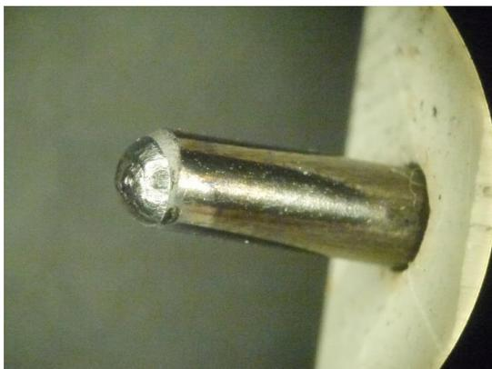
図 7 熔融接合した試料の写真
