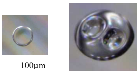
(左)0.06wt% 2.6 mPa·s (右)0.8wt% 6.0 mPa·s
