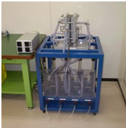
図 1 電気透析実験装置の外観 (膜面積: 117.5 cm 2 , 膜間距離: 1.5 mm, ユニットセル数: 10 対, 陽極: ステンレス (SUS), 陰極: 白金メッキチタン (Pt/Ti))
