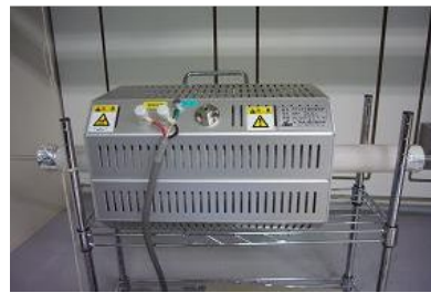
図2 燃焼装置(電気管状炉)
