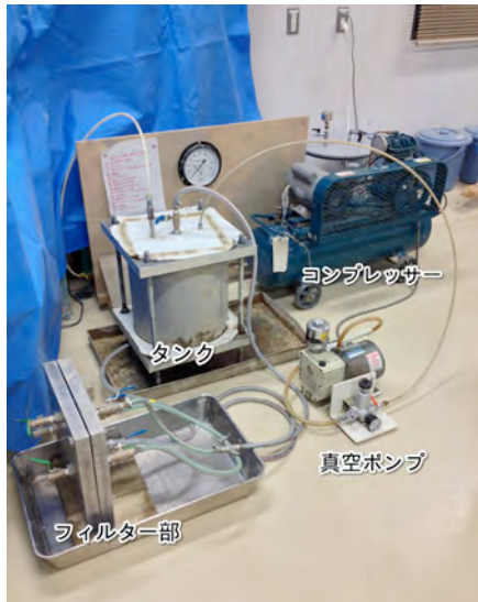
写真-1 フィルタープレス模型実験装置
