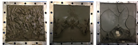
写真-3 脱水された泥土
