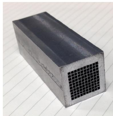
図3. 実験に供した 10 x 10 穴の鉛コリメータ。穴の断面積は 1.2 mm x 1.2 mm, 壁の厚みは 0.18 mm, 全長 60 mm である。
