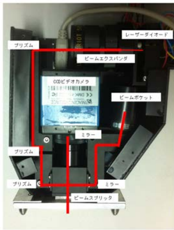
図4. 口腔内へ適応可能なサイズへ改良した血流計
