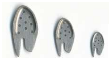
図1 試作された3サイズのインプラント 左からL、M、S。
