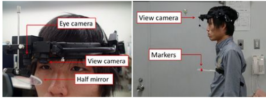
図 1 眼球・頭部運動同時計測システム
