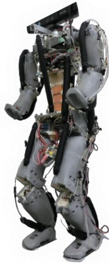
図 1 : コンプレッサ搭載型空気圧人工筋駆動ヒューマノイド buEnwa
