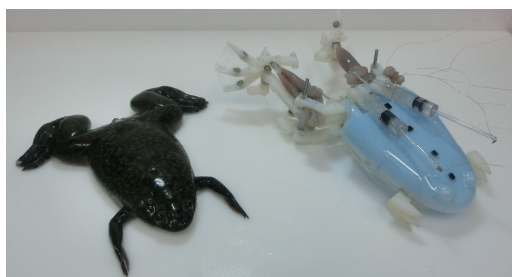
図1：筋肉組織を機械構造に取り付けた遊泳ロボット。左が生体のアフリカツメガエルであり、右側がロボットである。
