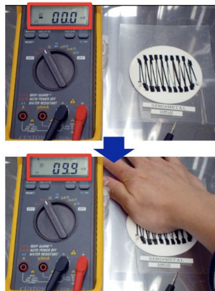
図2 カーボンナノチューブ薄膜による熱電変換のデモンストレーション
