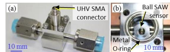
図 7 UHV センサセル(a)概観(b)内部構造
