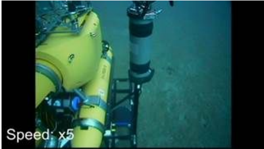
図6 海域でのドッキング中の様子 (駿河湾沿岸域 水深35m)
