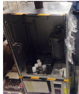
Fig. 3 塩化揮発装置
