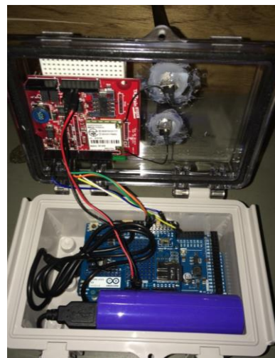
図 8 通信環境計測用無線センサノード
