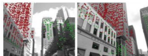
図6：繰り返しパターン検出アルゴリズムによる窓などの検出例。
