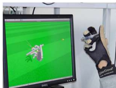
図2 手による物体操作の計測システム
