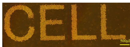
図5 インクジェットプリンターを用いた浮遊細胞のパターンニング
