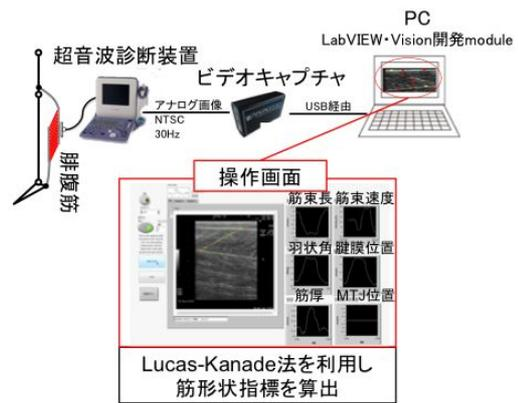
図2 申請者が構築した筋形状リアルタイム計測システム
