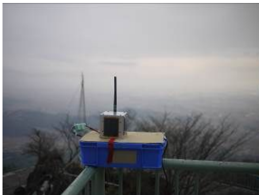
図 4-4-2-2 PreSatellite-2 と遠距離通信実験 (筑波山 産業技術高専間 60km)
