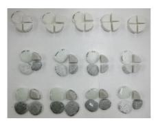
複雑形状の型におけるゲルキャスティングにおいて、一部離型、乾燥における変形が見られるため、離形後加工の必要があり、今後変形抑制への改良が望まれる。一方で、単純な形状の型でキャスティング後、複雑形状に加工することは可能であることが明らかになり、造形表現素材としての可能性が拡がった。手加工以外にもCNC加工機によるデジタル3Dデータを出力する成形素材としても利用可能であることが明かになった。
