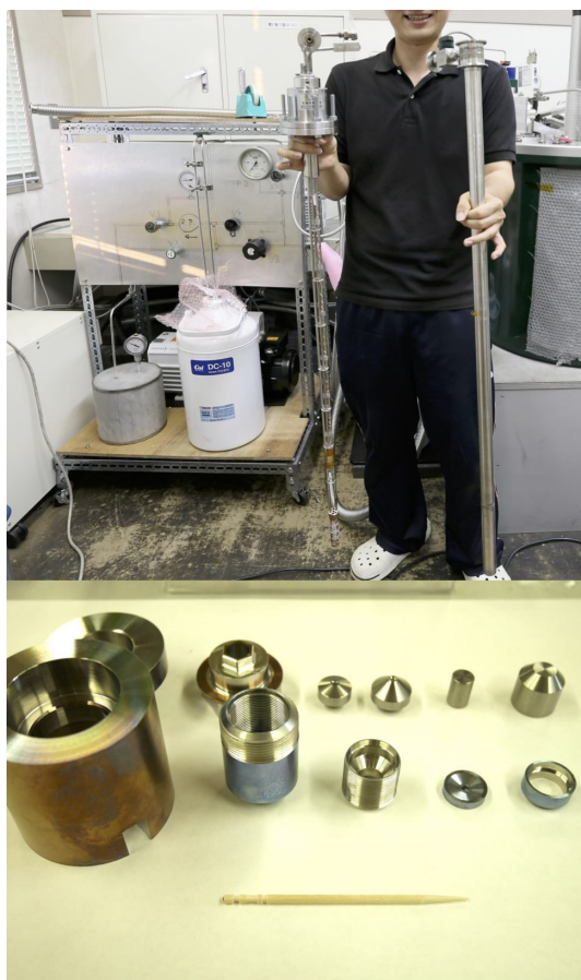
図2: 本研究期間に開発した、循環式 ^3\text{He} 冷凍 NMR プローブ(上)と小型化超高压セル(下)。これらの組み合わせにより、世界初の超高压・極低温 NMR 実験が可能になる。
