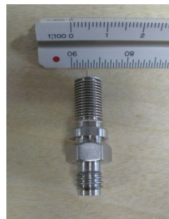
図 3：小型成型ベローズ（直径約 6 mm）
