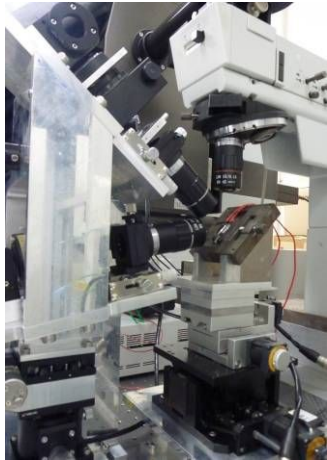
図 12 角度分散型顕微ラマン分光法による部分安定化ジルコニアの応力測定
