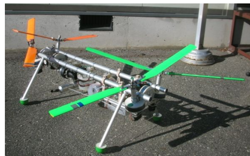
図7 交差反転式4発ロータヘリコプタ
