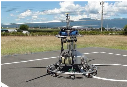
図4 固定ピッチ同軸二重反転式ヘリコプタ
